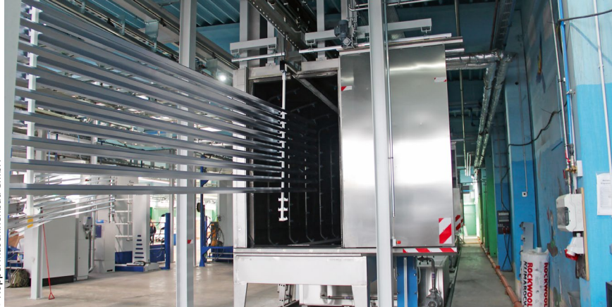
Erster Schritt der Beschichtungsprozesskette: Werkstücke fahren in die mehrstufige Vorbehandlungsanlage ein.
