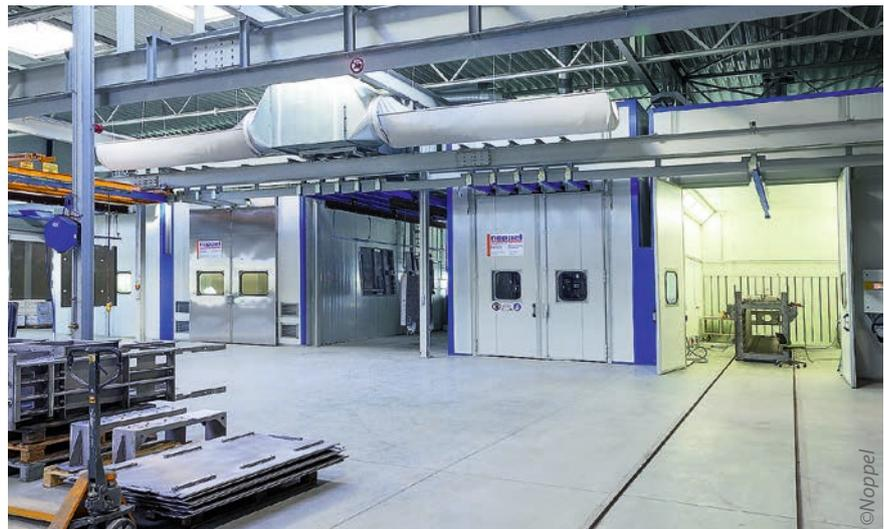
Pulverbeschichtung oder Nasslackierung – die neue Anlage ermöglicht beide Verfahren in der eigenen Fertigung
