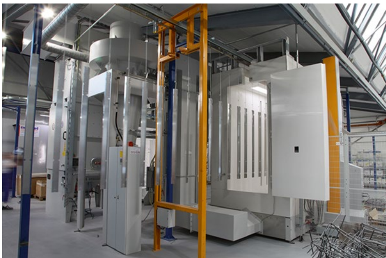
Die Anlage verfügt über eine Pulverlack-Rückgewinnung mit Zyklon und ein Schnellfarbwechselsystem.
