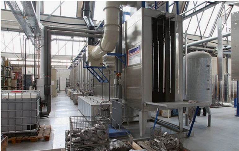
In der neuen Vorbehandlungsanlage können Aluminium- und Stahlteile auf höchstem Qualitätsniveau vorbehandelt werden.
