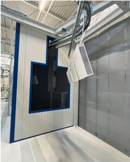
Der Ofen bei apra ist hybrid ausgelegt und lässt sich mit Gas oder Strom in beliebigem Verhältnis beheizen. Dabei ist der 100%ige elektrische Betrieb möglich, etwa wenn die hauseigene Solaranlage im Sommer genug Strom liefert.
