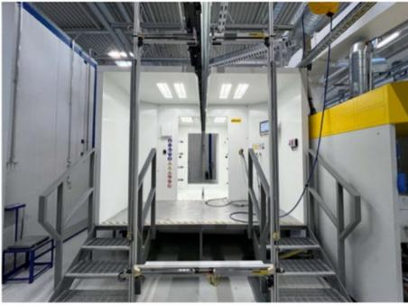
Großteils beschichtet apra mit einer automatischen Pulverkabine von Wagner.
