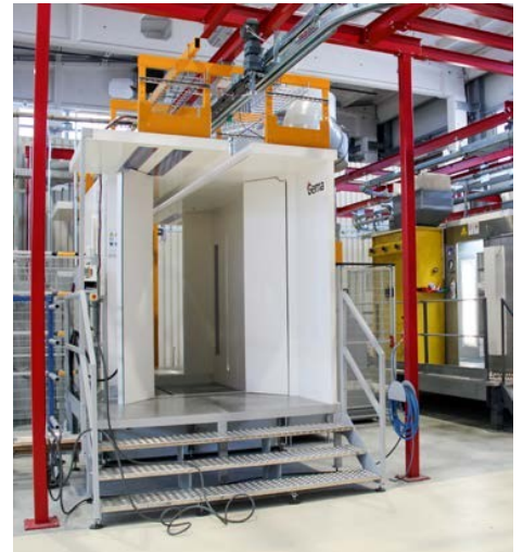
Die Lackierkabine steht, wie auch andere Anlagenkomponenten, erhöht. Die Höhenunterschiede gleichen flexible Gehänge von Emptmeyer aus.
