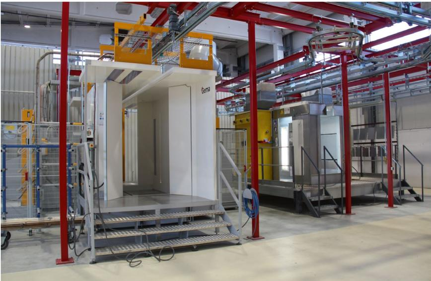
Parallel zur neuen Hand-/Automatik-Pulverbeschichtung mit Zyklon-Pulverrückgewinnung wurde eine Bestands-Hand-Pulverkabine in die Anlage integriert.
