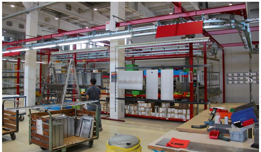
An der Aufgabestation werden die Fahrwege-Informationen und Prozess-Parameter mittels einfachem Barcode-Scan an die Anlagensteuerung übertragen.
