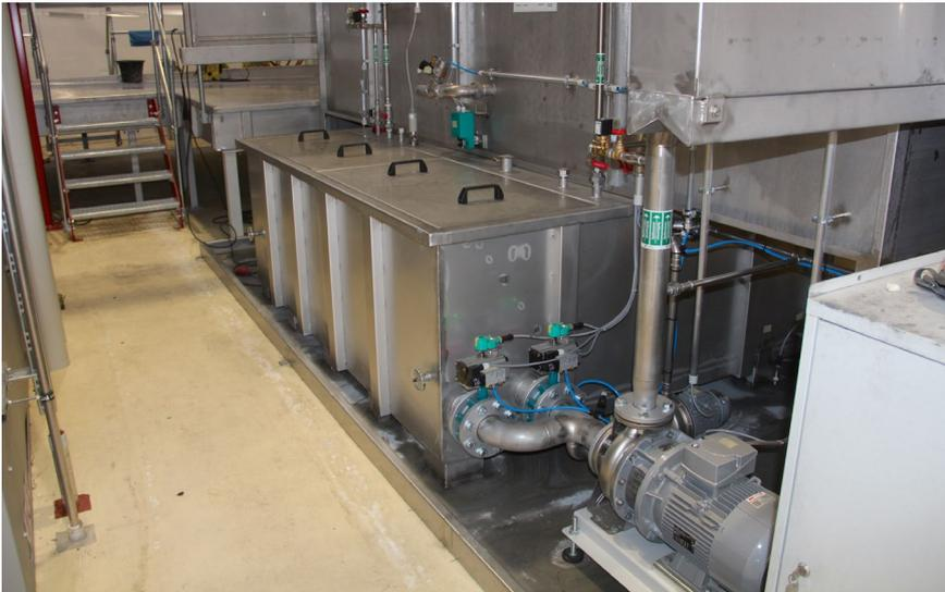
Die Anlage nutzt eine Vorbehandlung in einer 3-Kammer-Ausführung, um Stahl und Aluminium effizient zu behandeln.
